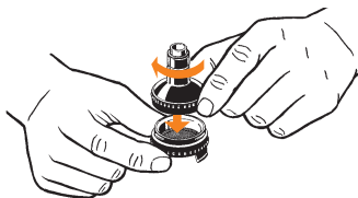
Deksel van de vulkamer vastschroeven
